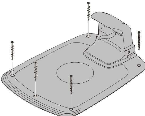
Zamocować stację ładowania do podłożu za pomocą pięciu dostarczonych śrub mocujących, użyć klucza imbusowego 6 mm.
