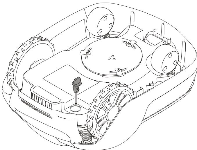
Vstavite varnostni ključ v spodnjo stran ksilnice in ga obrnite v položaj **Enable** (Omogoči).
