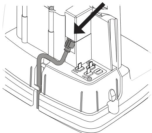
Conectați cablul de tensiune joasă la stația de încărcare.
