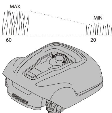
Stellen Sie in den ersten Wochen des Mähens die Schnitthöhe auf 60 mm ein, um das versehentliche Durchtrennen von Begrenzungsdraht und Führungsdraht zu vermeiden. Nachfolgend stufenweise jede Woche einen Schritt tiefer einstellen, bis die gewünschte Schnitthöhe erreicht ist.
