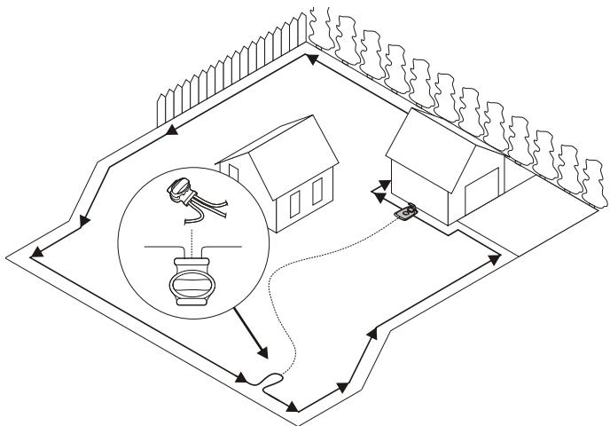
La tondeuse utilise le fil de guidage optionnel pour retrouver son chemin à la station de charge mais aussi pour identifier les endroits difficiles à atteindre dans la zone de travail. Par exemple, le fil de guidage est posé entre la station de charge et une partie distante de la zone de travail ou dans un passage étroit.
