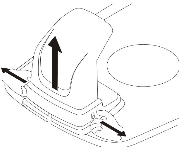
Remova a tampa protetora na estação de carregamento ao premir as guias de cada lado da base e levantar a tampa.
