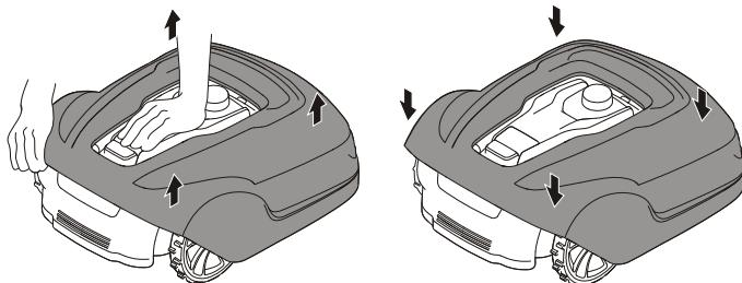
Hold plæneklipperen nede med den ene hånd, og løft med et fast tag et hjørne af kabinetten, og gentag for alle fire hjørner, indtil kabinetten løsner sig fra chassiset.
