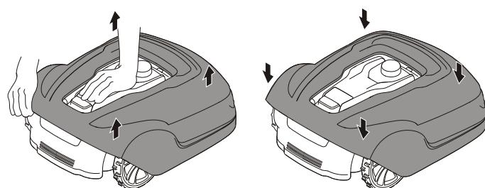
Sujete el cortacésped con una mano y levántelo firmemente por una de las esquinas del cuerpo y repita para las cuatro esquinas, hasta que el cuerpo se suelte del chasis.
