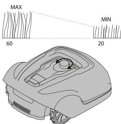
Ställ för de första veckornas klippning in klipphöden på 60 mm för att se till att begränsningskabeln och guidekabeln inte klipps. Sänk därefter inställningen ett steg varje vecka tills den önskade klipphöjden nås.
