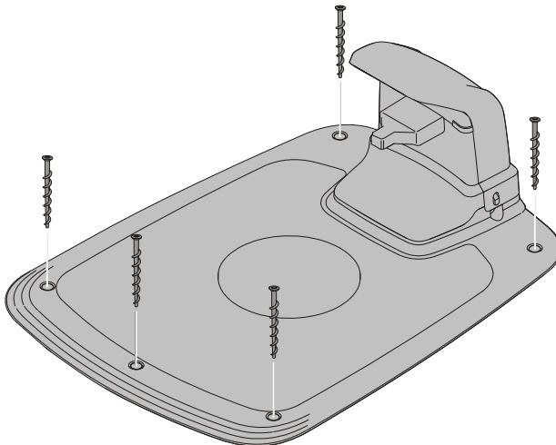
Pričvrstite stanicu za punjenje za tlo s pet vijaka isporučenih uz uređaj imbus ključem od 6 mm.
