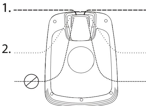
Suurimman osan latausasemasta on oltava työskentelyalueen sisäpuolella.
