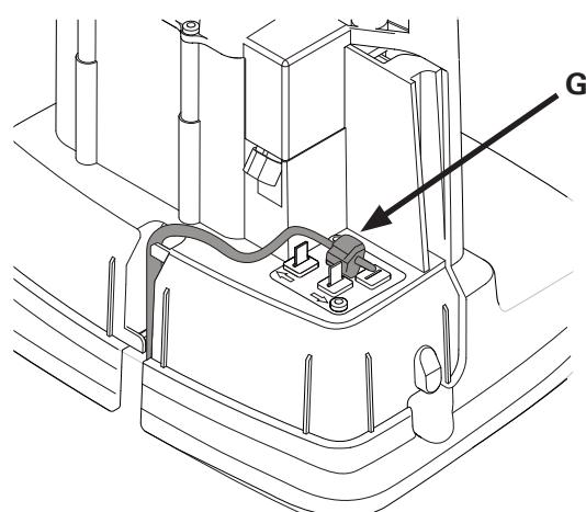
Вмъкнете двата края на ограничаващия проводник, както и края на направляващия проводник, в разклонението и конектора на направляващия проводник. Проверете дали проводниците са напълно вмъкнати в разклонението и конектора на направляващия проводник, така че краищата да се виждат през разклонението и конектора на направляващия проводник.
