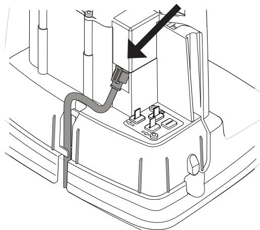
Csatlakoztassa a kisfeszültségű kábelt a töltőállomáshoz.
