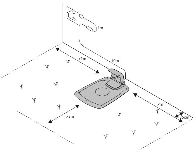
Pozitionarea stației de încărcare după cum urmează:
