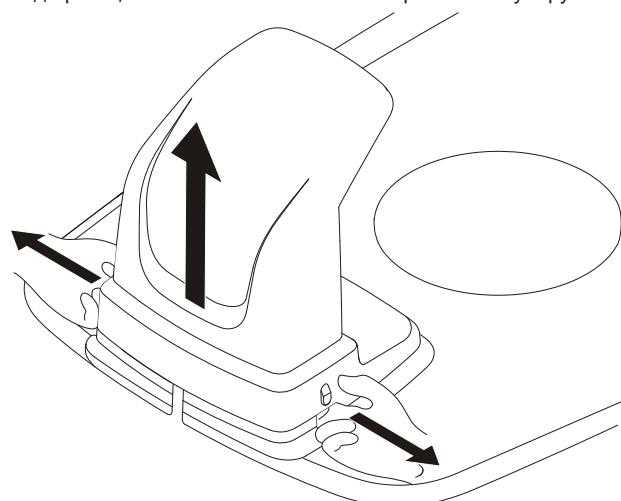
Нажав на выступы с каждой стороны основания, снимите защитную крышку с зарядной станции.
