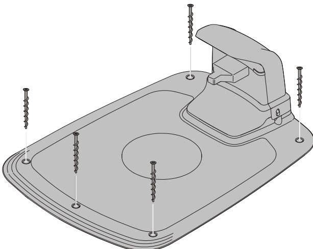
Arrimez la station de charge au sol avec les cinq vis de fixation fournies à l'aide d'une clé hex de 6 mm.
