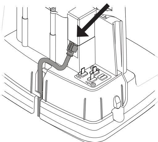
Podłączyć kabel niskonapięciowy do stacji ładowania.
