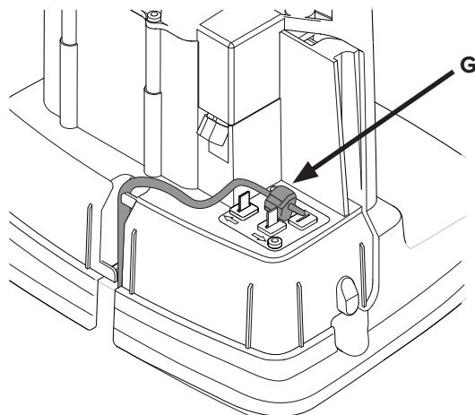
Připojte vodicí drát k nabíjecí stanici, a to následujícím způsobem:
