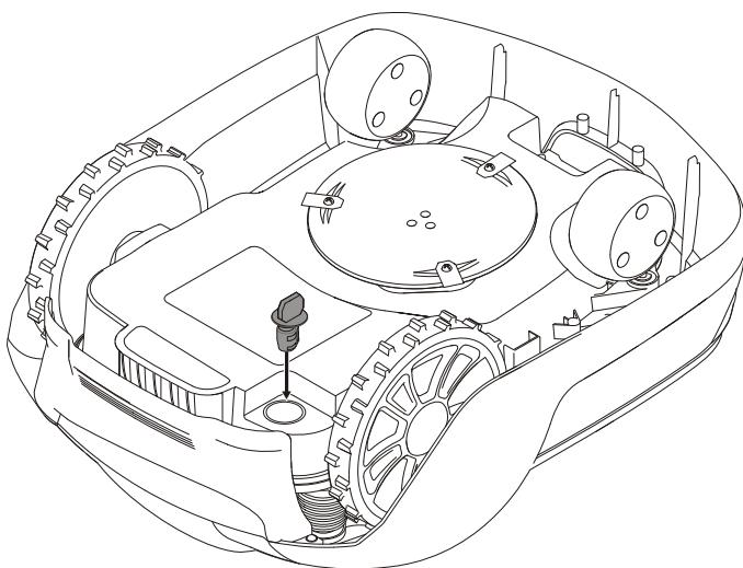
Włożyć klucz zabezpieczający do stacyjki w podwoziu kosiarki i przekręcić go w pozycję Włączone.
