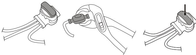
Vložte oba konce ohraničujícího drátu a konec vodicího drátu do spoje a spojky vodicího drátu. Zkontrolujte, zda jsou dráty plně zasunuty do spoje a spojky vodicího drátu tak, aby byly konce přes spoj a spojku vodicího drátu viditelné.
