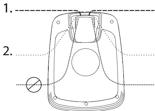
Coloque la estación de carga de la siguiente manera:
