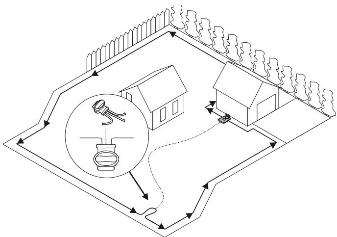
Kosiarka wykorzystuje opcjonalny przewód prowadzący, za pomocą którego odnajduje drogę powrotną do stacji ładowania, przewód prowadzący pomaga też znaleźć trudno dostępne fragmenty terenu w strefie pracy. Na przykład, przewód prowadzący może zostać położony między stacją ładowania a odległą częścią strefy pracy lub w wąskim przesmyku.
