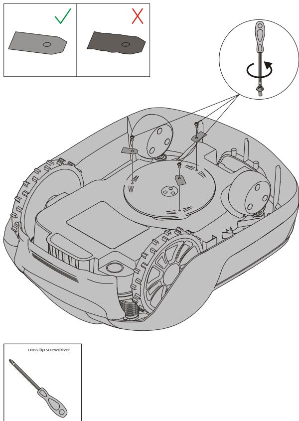
**AVERTISMENT!** Apăsați butonul STOP și îndepărtați cheia de siguranță înainte de a înlocui lamele și purtați mănuși de protecție.
