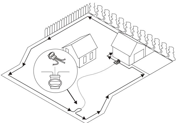
Robotul de tuns iarba utilizează firul de ghidare opțional pentru a-și regăsi drumul înapoi la stația de încărcare, dar și pentru a accesa spații greu de accesat din zona de lucru. De exemplu, firul de ghidare este instalat între stația de încărcare și o porțiune îndepărtată din zona de lucru sau printr-un spațiu îngust.
