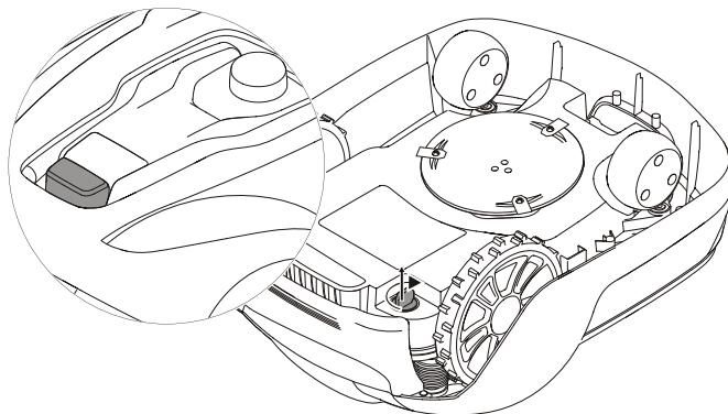
Нажмите кнопку СТОП на газонокосилке и выньте ключ безопасности.
