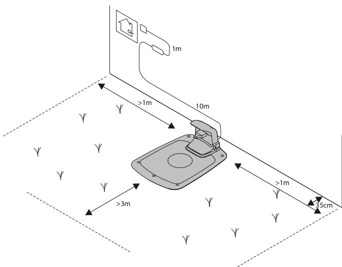
Stację ładowania należy ustawić w następujący sposób:
