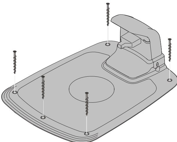
Säkra laddstationen mot marken med de fem medföljande fästskruvorna med hjälp av insexnyckeln på 6 mm.
