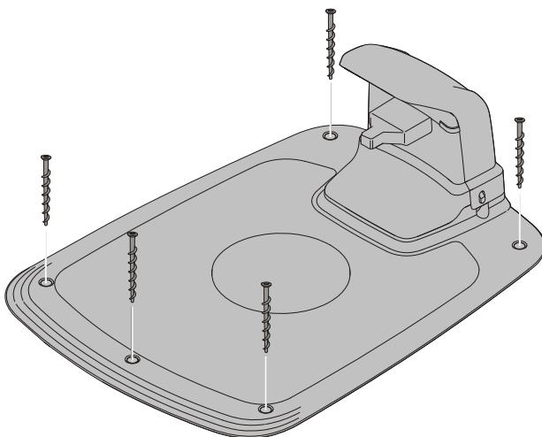
Připevněte nabíjecí stanici k zemi pomocí pěti dodaných upevňovacích šroubů s použitím 6mm imbusu.
