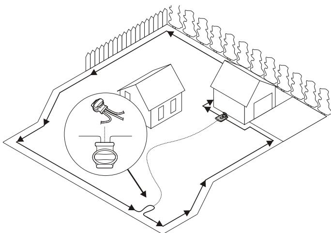
L'apparecchio utilizza il filo di Guida aggiuntivi per trovare il percorso a trovare la stazione di ricarica, ma anche le aree difficili da raggiungere dell'area di lavoro. Per esempio, il cavo di guida sui tra la stazione di ricarica e telecomando l'area di lavoro o un punto specifico.
