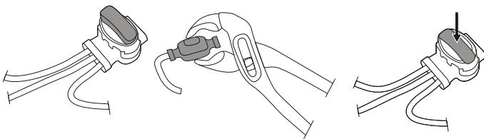
Stop beide uiteinden van de begrenzingsdraad en het uiteinde van de begeleidingsdraad in het begeleidingsdraad-verbindingsstuk. Controleer of de draden volledig in het begeleidingsdraad-verbindingsstuk zijn gestopt zodat de uiteinden door het begeleidingsdraad-verbindingsstuk zichtbaar zijn.
