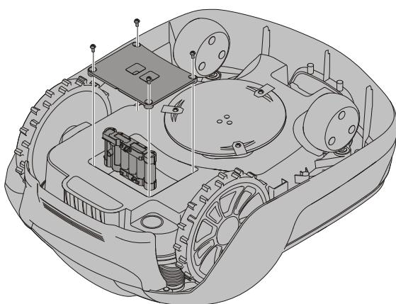
**VARNING!** Tryck på **STOPP**-knappen och ta ur säkerhetsnyckeln innan du byter ut batterierna. Använd skyddshandskar.
