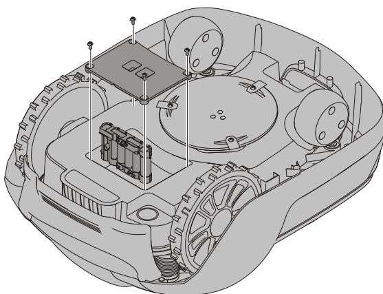
**VAROVÁNÍ!** Stiskněte tlačítko STOP a před výměnou baterií vyjměte bezpečnostní klíč; použijte ochranné rukavice.
