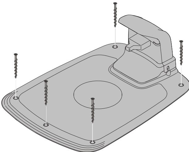
Fastgør ladestationen til underlaget med de fem medfølgende skruer ved hjælp af en 6 mm unbrakonøgle.
