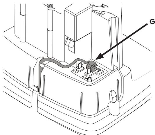
Inserte ambos extremos del cable delimitador así como el extremo del cable de guía en el conector de empalme y de cable de guía. Compruebe que los cables estén totalmente insertados en el conector de empalme y de cable de guía de manera que los extremos sean visibles a través del conector de empalme y de cable de guía.
