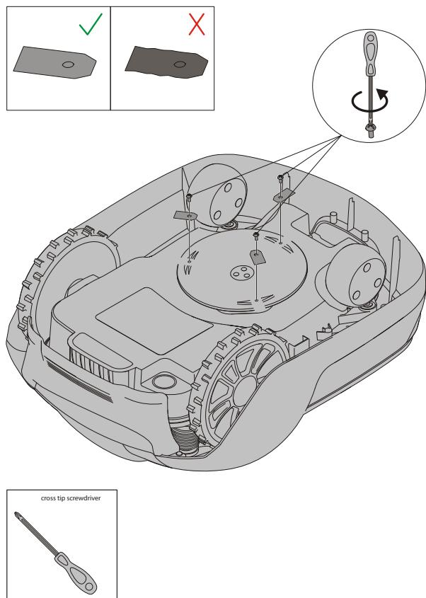
**VAROVÁNÍ!** Před výměnou nožů stiskněte tlačítko STOP a vyjměte bezpečnostní klíč; použijte ochranné rukavice.
