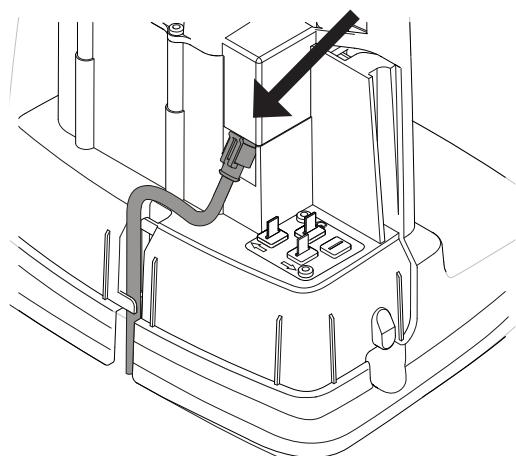
Zapojte nízkonapěťový kabel do nabíjecí stanice.
