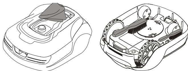
**WARNUNG!** Drücken Sie die STOP-Taste und entfernen Sie den Sicherheitsschlüssel vor der Reinigung.
