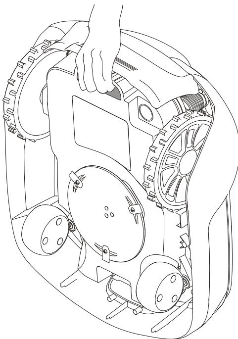
Перед тем как поднять газонокосилку, нажмите кнопку **СТОП** и выньте ключ безопасности.
