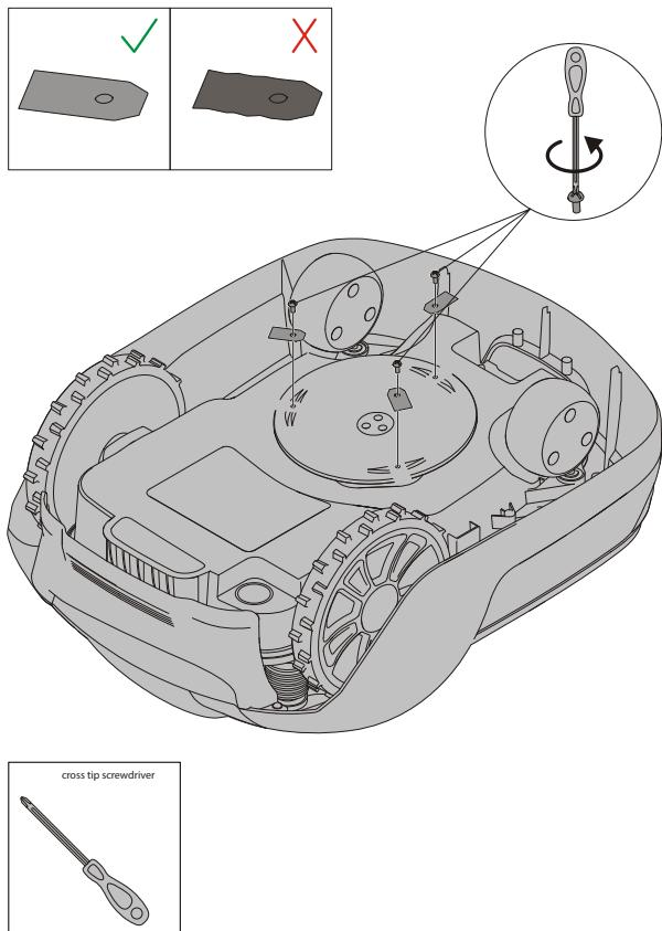
**AVISO!** Pressione o botão STOP e remova a chave de segurança antes de substituir as lâminas e use luvas de proteção.
