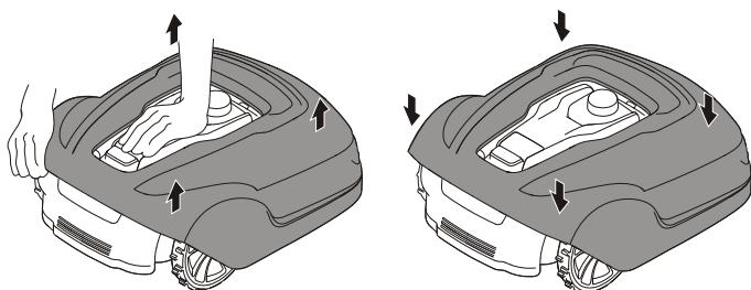
Čvrsto držite kosilicu dolje jednom rukom i čvrsto podignite jedan od uglova kućišta i ponovite to za sva četiri ugla dok se kućište uz prigušeni pucanj ne odvoji od šasije.
