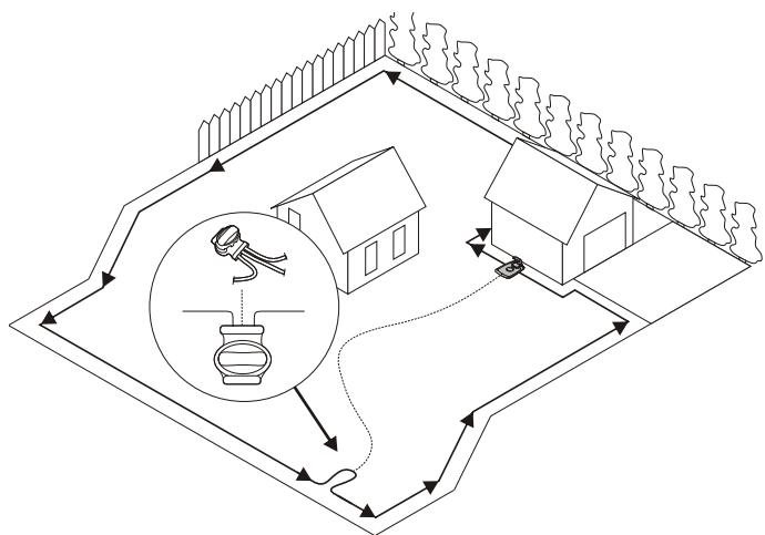
El cortacésped utiliza el cable de guía opcional para encontrar el camino de regreso a la estación de carga, pero también para encontrar zonas de difícil acceso en la superficie de trabajo. Por ejemplo, el cable de guía se coloca entre la estación de carga y una parte remota de la superficie de trabajo o a través de un pasaje estrecho.
