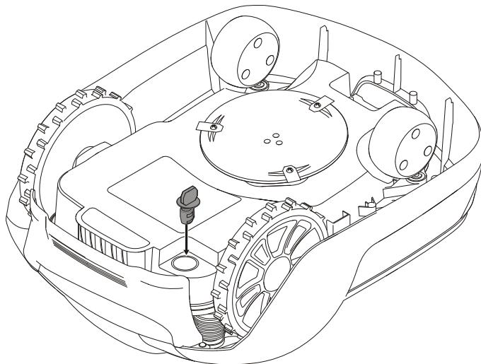
Inserte la llave de seguridad en la parte inferior del cortacésped y gírela a la posición **activada**.
