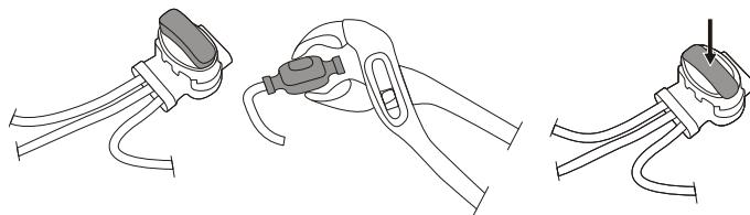
Insérez les deux bouts du fil périphérique avec le bout du fil de guidage dans le connecteur de fil de guidage et d'épissure. Assurez-vous que les fils sont bien insérés dans le connecteur de fil de guidage et d'épissure de sorte que les bouts soient visibles à travers le connecteur de fil de guidage et d'épissure.
