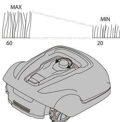
Během prvních několika týdnů sekání nastavte výšku sekání na 60 mm, aby nedošlo k přeřezání ohraničujícího drátu a vodicího drátu. Poté každý týden snižte nastavení o jeden krok, až dosáhnete požadované výšky sekání.
