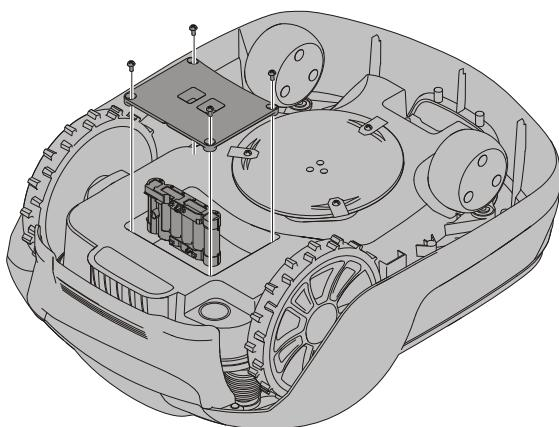
**VAROVANIE!** Stlačte tlačidlo STOP a pred výmenou batérií vyberte bezpečnostný kľúč a nasadťte si ochranné rukavice.
