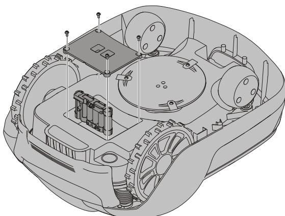
**AVVERTENZA!** Premere il tasto STOP e rimuovere la chiave di sicurezza prima di sostituire le batterie e indossare guanti di protezione.
