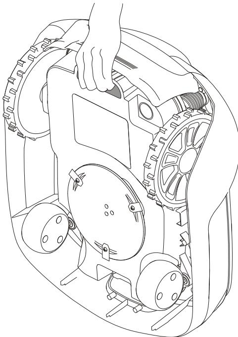
Trykk på **STOPP**-knappen på gressklipperen og ta ut sikkerhetsnøkkelen før du løfter gressklipperen.
